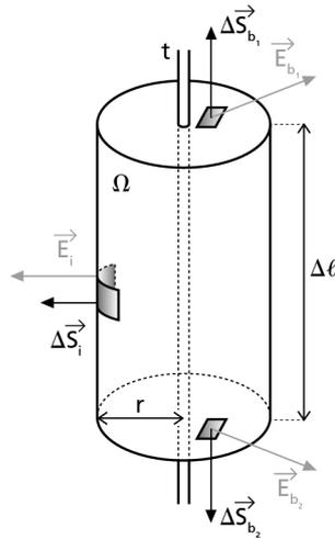
Sulle due basi del cilindro, i vettori superficie sono ovunque perpendicolari ai corrispondenti vettori campo elettrico, per cui il flusso di campo elettrico attraverso di esse è nullo.
