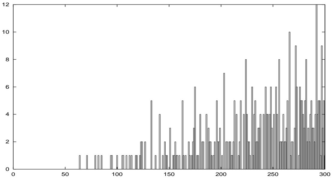
Fig. 7: Numero di modi per intervallo di frequenza per una cavità di 1x2x3 metri cubi.
