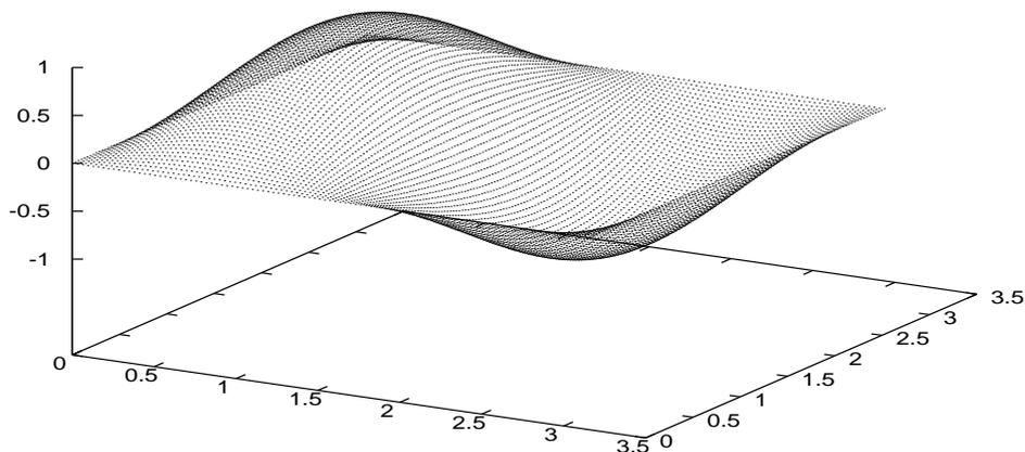
Fig. 1: Configurazione del modo normale  $m=1, n=2$  per una membrana rettangolare.
