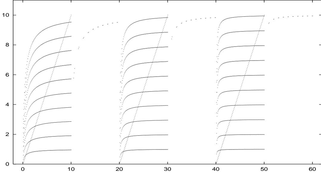
Fig. 5: Soluzioni grafiche dell'equazione  $\omega_k = \frac{k}{\sqrt{1+b/\omega_k}}$ ;  $k = 1, 2, \dots, 10$  per 3 valori di  $b = 3, 1, 1/3$ , rapporto tra la frequenza in aria e quella nel vuoto: NB nel grafico tale rapporto è moltiplicato per 10.
