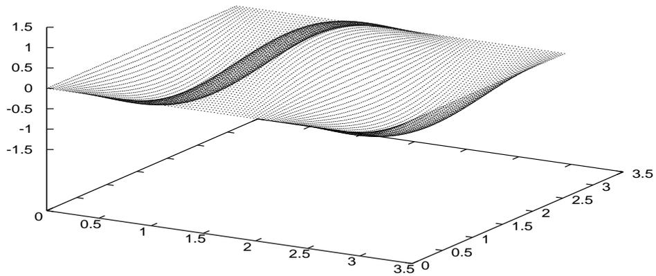
Fig. 2: Configurazione del modo normale  $m=1, n=3$  per una membrana rettangolare.
