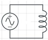
$$V(t) = V_{\max} \cdot \text{sen}(\omega t) \quad I(t) = -\frac{V_{\max}}{\omega L} \cdot \cos(\omega t) = \frac{V_{\max}}{\omega L} \cdot \text{sen}\left(\omega t - \frac{\pi}{2}\right)$$
