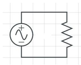
$$V_R = V(t) = \omega AB \cdot \text{sen}(\omega t) = V_{\max} \cdot \text{sen}(\omega t)$$
