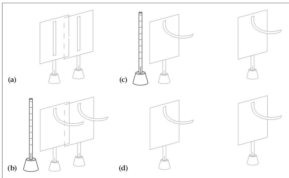
Figura 7.16. Prima procedura di caricamento per induzione.
