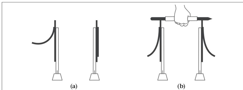
Figura 6.33. (a) Solo l'elettroscopio *I* viene caricato. (b) Un spiedino di legno è infilato in una cannucchia di plastica, con le estremità di legno sostenute dai due elettroscopi. Osserviamo che la striscia *I* si abbassa un po', mentre la striscia *II* si solleva un po'.
