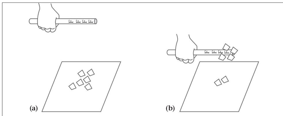
Figura 2.3. (a) Una cannucchia strofinata posta a distanza da piccoli pezzi di carta. (b) La cannucchia, una volta strofinata, attrae i pezzi di carta quando la si avvicina ad essi.
