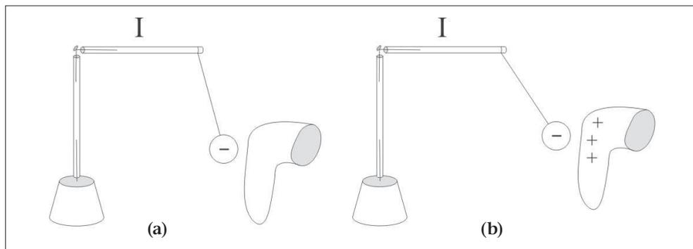
Figura 5.7. (a) L'attrazione tra una calza neutra e un pendolo negativo è minore dell'attrazione tra pendolo negativo e calza positiva, (b).
