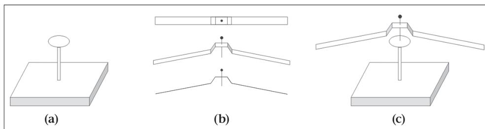
Figura 3.5. Versorium del secondo tipo, con la puntina fissata sulla sua parte mobile. (a) Basetta fissa del versorium. (b) "Cappello" del versorium (striscia di plastica o di metallo) con la puntina collegata ad esso. (c) Versorium montato.
