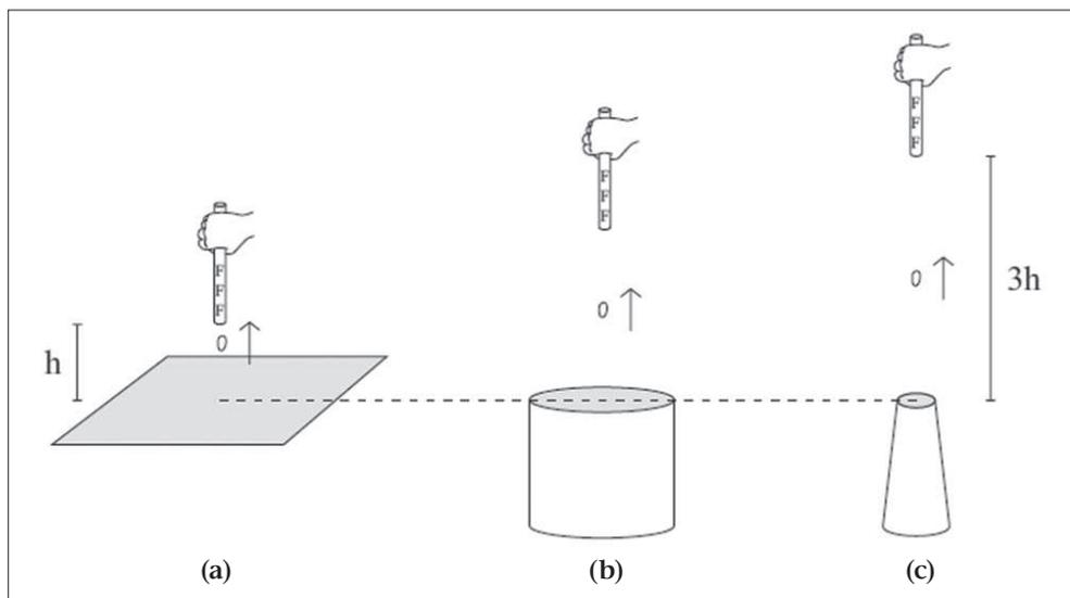
Figura B.22 (a) Una piccola foglia di ottone è attratta da un'altezza  $h$  dalla sua posizione iniziale al suolo. (b) Essa si solleva di più quando è posta su un tavolo o su un cilindro conduttore di 30 cm di diametro. (c) Quando è su un conduttore conico, è attratta tre volte di più rispetto a quando è sul pavimento.
