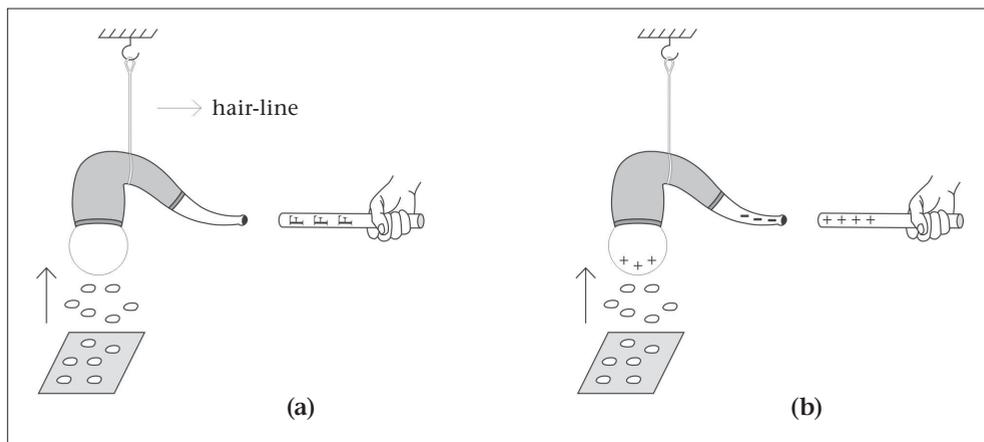
Figura B.16 (a) una bolla di sapone che attrae foglie d'ottone quando il tubo di vetro strofinato viene portato in prossimità della pipa sospesa tramite un *hair-line* [filo di crine o filo setoso], un isolante. (b) Rappresentazione qualitativa delle cariche nel caso (a).
