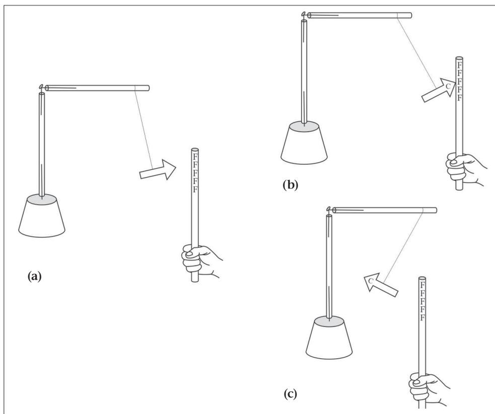
Figura 4.32. (a) Inizialmente la freccia punta verso la plastica strofinata, siccome è attratta da essa. (b) Essa tocca la cannucchia. (c) Dopo il contatto, la freccia è respinta dalla cannucchia, con la punta della freccia orientata in direzione opposta alla cannucchia.
