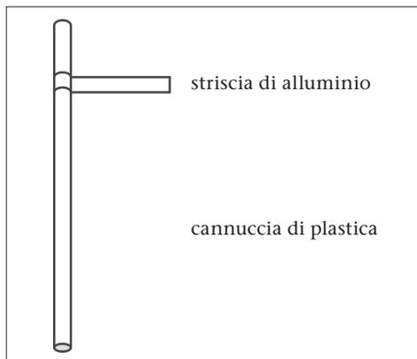
Figura 7.3. Un terzo modello di collettore di carica.
