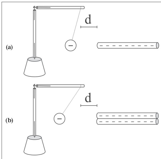
Uniamo le due cannuccie sfregate e portiamole alla stessa distanza  $d$  dal pendolo elettrico carico. Osserviamo che il pendolo devia di un angolo maggiore di  $\vartheta$  dalla verticale, come in Figura 5.30 (b). Questo esperimento infatti, insieme alla definizione precedente, mostra che due corpi ugualmente carichi, se messi insieme, hanno una carica maggiore di ciascuno di questi corpi individualmente.
