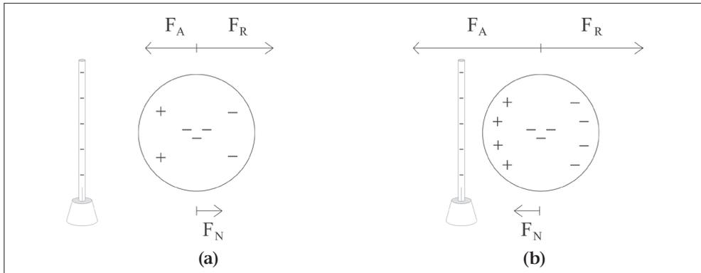
Figura 7.35. (a) La forza repulsiva  $|F_R|$  è più grande della forza di attrazione  $F_A$ . (b) Quando la distanza tra i due corpi diminuisce,  $F_A$  aumenta più di  $|F_R|$ . Alla breve distanza mostrata in figura, la forza di attrazione diventa maggiore della forza repulsiva.
