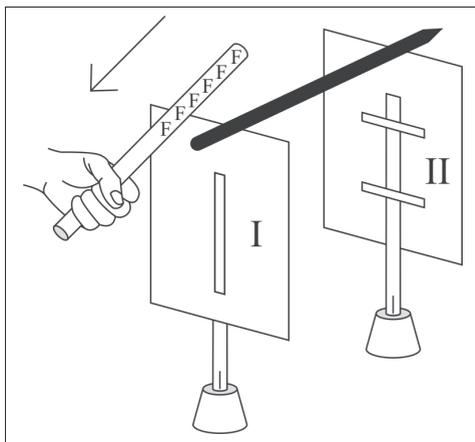
Figura 6.19. Due elettroscopi inizialmente scarichi sono collegati da uno spiedino di legno. Una cannuccia elettrizzata è strisciata solo contro l'elettroscopio I.
