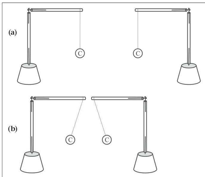
A volte è necessario utilizzare fili di seta molto sottili, al fine di vedere questa separazione laterale. Quando i fili sono molto densi e pesanti, il loro peso ne riduce l'angolo. Inoltre, fili più corti creano angoli di separazione tra loro superiori rispetto ai fili più lunghi, a parità di distanza finale tra i dischi di carta. Ciò significa che fa comodo lavorare con fili corti poiché questo rende la repulsione più visibile.
