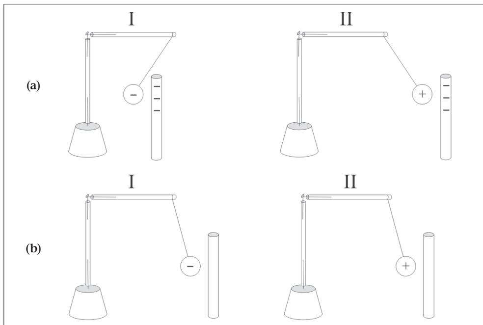
Figura 5.8 (a) Un corpo negativo (la cannucia strofinata) respinge un altro corpo negativo (il disco di carta del pendolo *I*) ed attrae fortemente un corpo positivo (il disco di carta del pendolo *II*). (b) Un corpo neutro (la cannucia non strofinata) attrae corpi negativi e positivi (i dischi di carta dei pendoli *I* e *II*). Inoltre, le intensità di queste forze nei casi (a) sono superiori a quelle che si manifestano nei casi (b).
