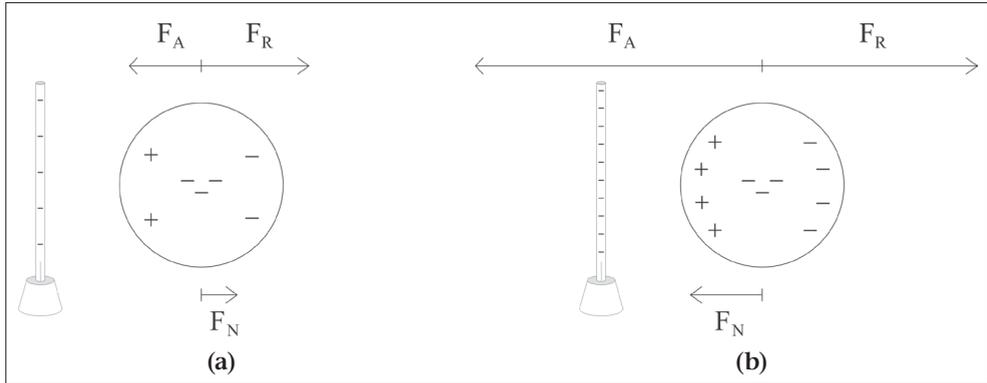
Figura 7.34. (a) Forza repulsiva più grande della forza di attrazione. (b)  $F_A$  aumenta più di  $|F_R|$  a causa di un aumento della quantità di carica nell'isolante vicino. Qui mostriamo una situazione nella quale la forza di attrazione è diventata maggiore della forza repulsiva.
