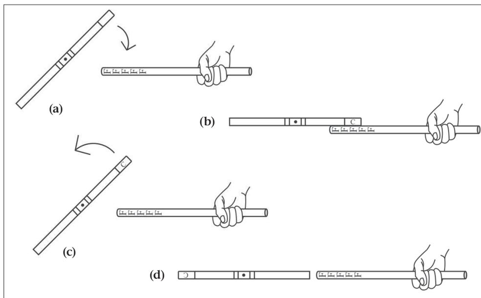
Figura 4.24. (a) L'alluminio è inizialmente attratto dalla plastica strofinata. (b) L'alluminio tocca la porzione strofinata della cannucia. (c) Dopo il contatto, l'alluminio viene respinto dalla cannucia. (d) Orientamento del versorium all'equilibrio finale.
