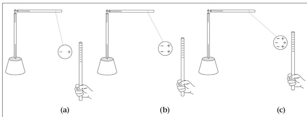
Figura 7.9. Diminuendo la distanza tra una cannucchia strofinata e un pendolo, aumentiamo la polarizzazione delle cariche indotte sul disco conduttore.
