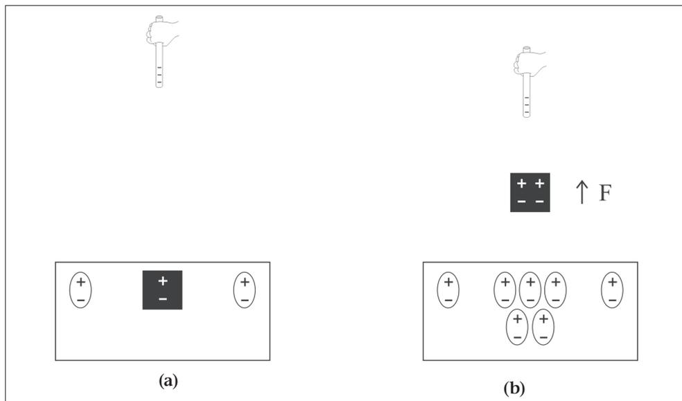
Figura 8.5. (a) Un pezzo di carta polarizzato appoggiato su un pannello di polistirolo polarizzato in presenza di una cannucia elettrizzata che è lontana dalla carta. (b) Spostando la cannucia ancora di più verso la carta, aumentiamo la polarizzazione della carta e del polistirolo. Questo crea una forza elettrostatica attrattiva sul foglio, che può essere più grande rispetto al suo peso. Se questo accade, la carta si muove verso la cannucia.
