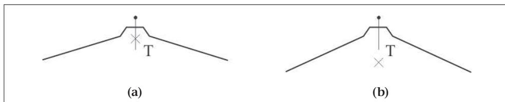
Figura 3.8. Il simbolo  $\times$  rappresenta il baricentro  $C$  della parte mobile del versorium (composta dallo spillo e dal cappello). (a) Versorium del secondo tipo in equilibrio instabile, con  $\times$  al di sopra della punta  $T$  dello spillo. (b) Versorium in equilibrio stabile, con  $\times$  al di sotto della punta  $T$ .
