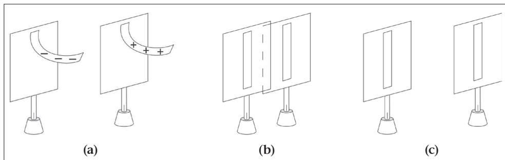
Figura 6.30. (a) Un elettroscopio positivo ed uno elettroscopio negativo. (b) Dopo il contatto, le strisce cadono. (c) Dopo la separazione, le strisce rimangono verticali, indicando che gli elettroscopi sono ora scarichi.
