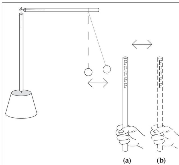
Figura 4.17. Un pendolo elettrico segue il moto di un pezzo di plastica strofinata. (a) Quando la cannucchia è portata vicino al disco di carta, la carta si muove verso di essa. (b) Quando la cannucchia viene allontanata, il pendolo ritorna alla direzione verticale.
