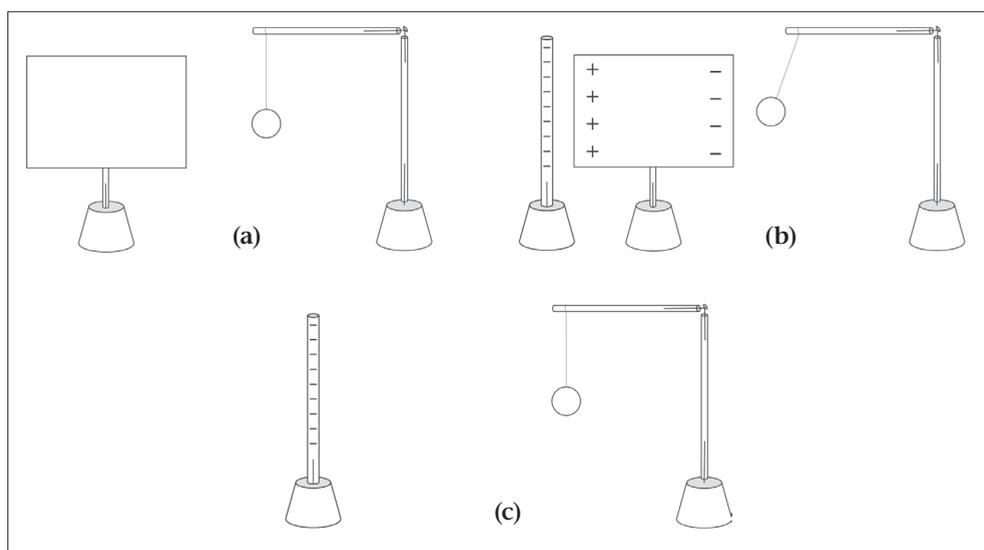
Figura 7.12. (a) Un pendolo neutro è sospeso verticalmente vicino ad un rettangolo conduttore neutro (bordo sinistro *A* e bordo destro *B*). (b) Quando una cannuccia strofinata è portata in prossimità di un bordo del rettangolo, il pendolo è attratto dall'altro bordo. (c) Quando togliamo il rettangolo conduttore, il pendolo torna alla verticale.
