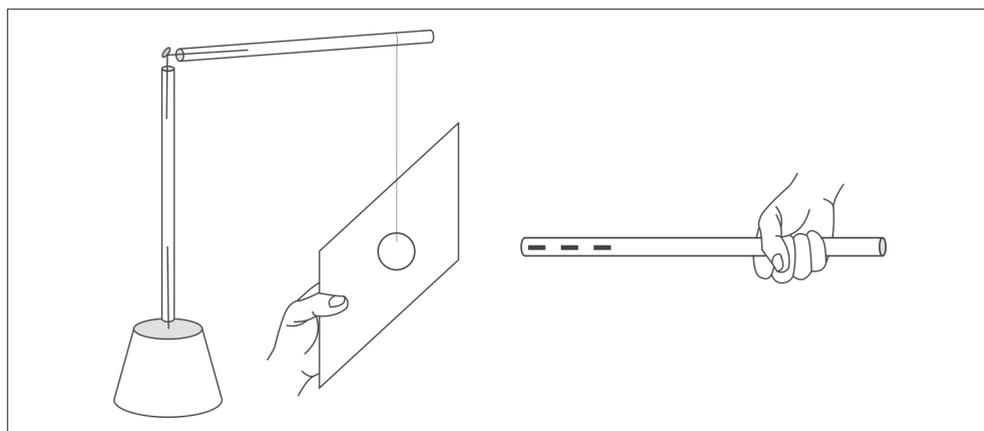
Figura 7.46. Inizialmente il disco di carta di un pendolo elettrico tocca il foglio di carta o la piastra metallica.
